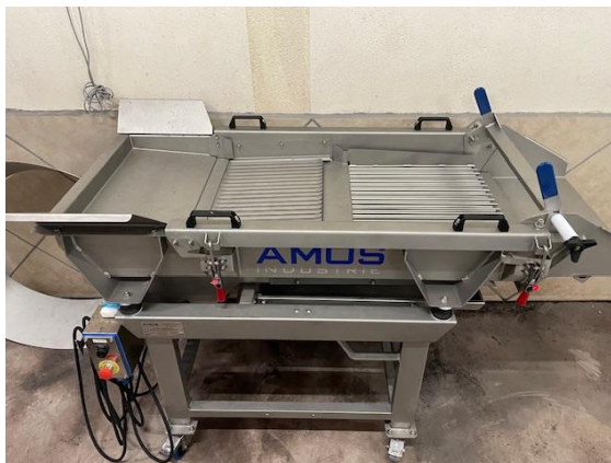
een elektrische trieertafel met trilfunctie
