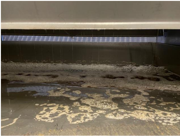
geperst druivensap wordt opgevangen onderaan de pers
